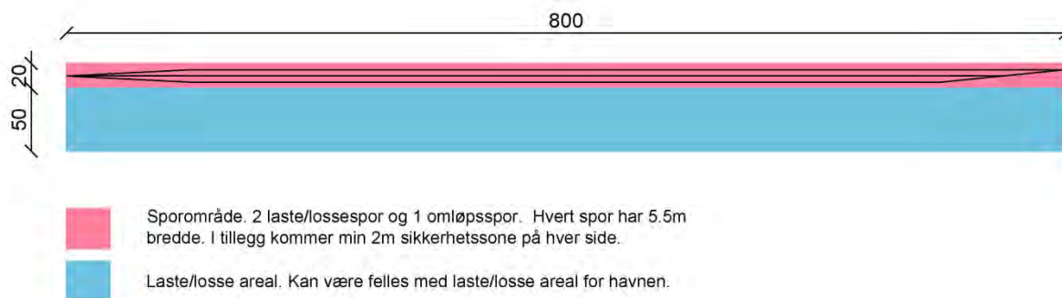
Figur 13 Arealbehov for jernbaneterminal med laste/losse areal
